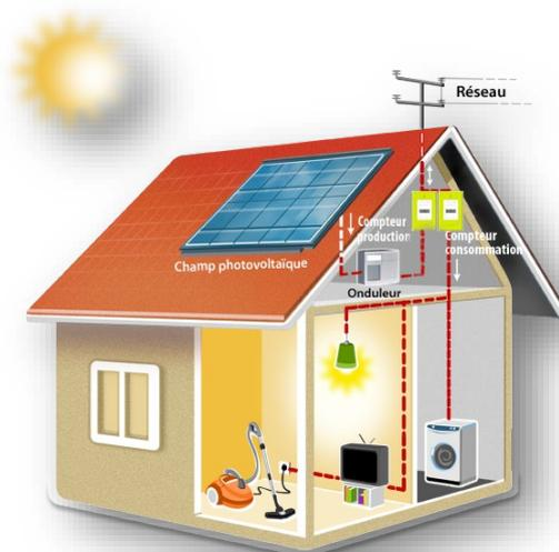
Figure 1 : Exemple d'installation photovoltaïque avec injection réseau (Source : Hespul)
