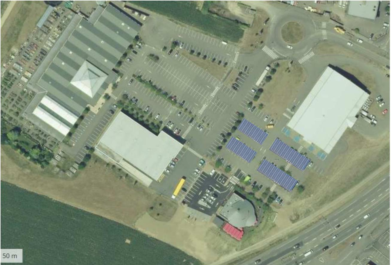
Les hypothèses retenues pour le calepinage sont avec une inclinaison à 30°, azimut -31 :
